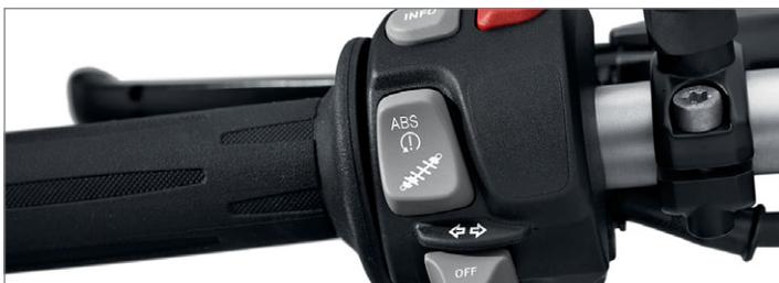
Für die Sicherheit beim Bremsen sorgt das serienmäßige kompakte und leichte BMW Motorrad 2-Kanal-ABS. Das optional abschaltbare ASC (Automatic Stability Control) regelt bzw. optimiert die Kraftübertragung und verhindert das Durchdrehen des Hinterrades z. B. auf nasser Fahrbahn. Im Gelände können beide Systeme entweder abgeschaltet oder aber über Fahrmodi Pro auf die Anforderungen abseits eingefahrener Wege angepasst werden. Denn die BMW F 800 GS Adventure kennt keine Grenzen.
